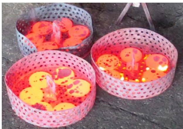
Рис. 4. Дослідні зразки після нормалізаційного відпалу
