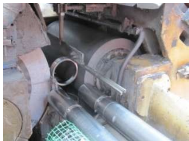
Рис. 9. Налаштування безцентрово-круглошліфувального верстату SASL5AD
