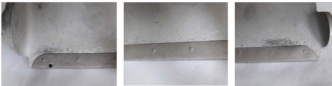
Рис. 12. Загальний вигляд фрагментів лопатки вхідного направляючого апарату реактивного авіадвигуна з ділянками руйнування поверхні корпусу, виготовленого з алюмінієвого сплаву марки ВД-17
